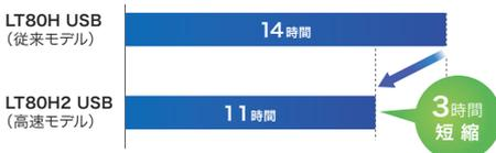
LT80H2、LT70H2 USBは、従来モデルであるLT80H、LT70H USBよりも25%の転送速度向上を実現しました。SASインターフェースを搭載できないノートPCでも手軽に利用でき、転送速度はSAS接続と同等の300MB/sへと飛躍的に向上したことから、ストレスフリーなバックアップ/アーカイブへのメリットは計り知れません。
