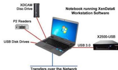
「X2500-USB-JP」システムは、end-to-end logical block protection(LBP)の利用によって、LTO に書き込まれるデータをリアルタイムでベリファイします。LBP 技術により、追加の読み出し操作を必要とすることなく、データの保全性が保証されます。ファイルをリストアする際には、テープ上に記録されている順に LTO からファイルを読み出します。小ファイルを大量に読み出す場合には、この方法により、全体の転送時間が劇的に改善されます。
