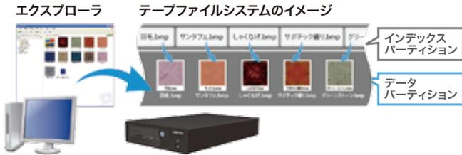
テープをインデックスパーティションとデータパーティションに二分割し(パーティショニング)、インデックスパーティションにデータの情報を索引として記録し、データの直接検索を可能にします。
