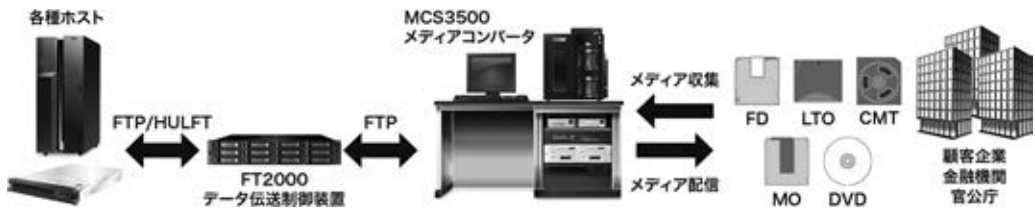
図1 全銀協対応媒体受入返却システム「MCS 3500」の構成
