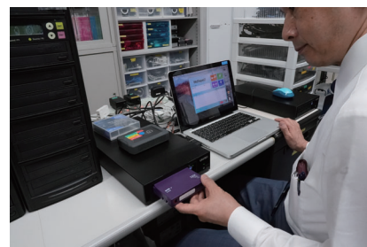
LTO-5 を右側に、LTO-7 を左側に配置し、メディアによってどちらの装置もすぐに使用できる環境を整えています。
