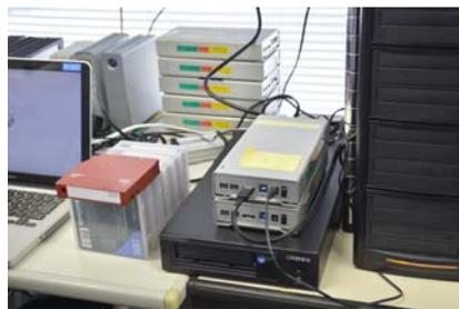
「LTOテープへのアーカイブを検討し始めてから各メーカーのシステムを比較しましたが、そのほとんどがLTOドライブ装置、専用のパソコン、アーカイブソフトなどから構成されており、高額なものばかり。さらに、映像をビデオテープから改めてデジタル化しなければならぬため、時間も人員も必要になる。そうしたなかで、手持ちのノートPCを利用し、ノンリニア編集のためにすでにデジタル化した映像データをそのままの形式でLTOテープに保存でき、
